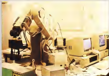
L'organo di presa montato sul PUMA 508 permette al robot di percepire la più piccola delle sfere ad esso sotteso e apprenderlo il tatto.
